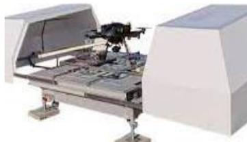
配備拠点にドローンポートを常設し、ドローンの運用を簡略化します。またcloudGCSからの制御により開閉、機体充電等のポート制御により【24365運用体制】
