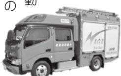
このポンプ自動車は、ディーゼルエンジン4.0ℓの排気量・4輪駆動方式で、従来のポンプ自動車の機能に加え、600ℓの水槽と消火薬剤としてCAFS装置※を積載しています。
