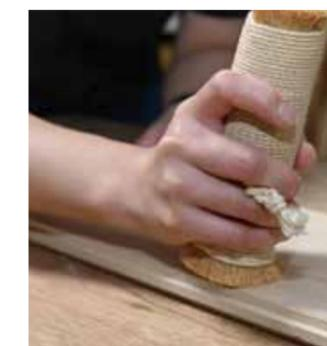
組み立てた胴の表面を草の根で作られた小さなブラシで削る「うずくり」を行う。削ることで、木目がきれいに浮かび上がる。その後、木の煮汁に、細かい粒子状の「砥」の粉を混ぜたものを塗り重ね、さらに木目を引き立たせる。全体をコーティングし、扉や引出しをはめて、金具をつけて、完成となる。
