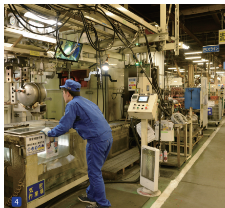
4 完成した製品は、水につけて目視で気密性をチェック。
